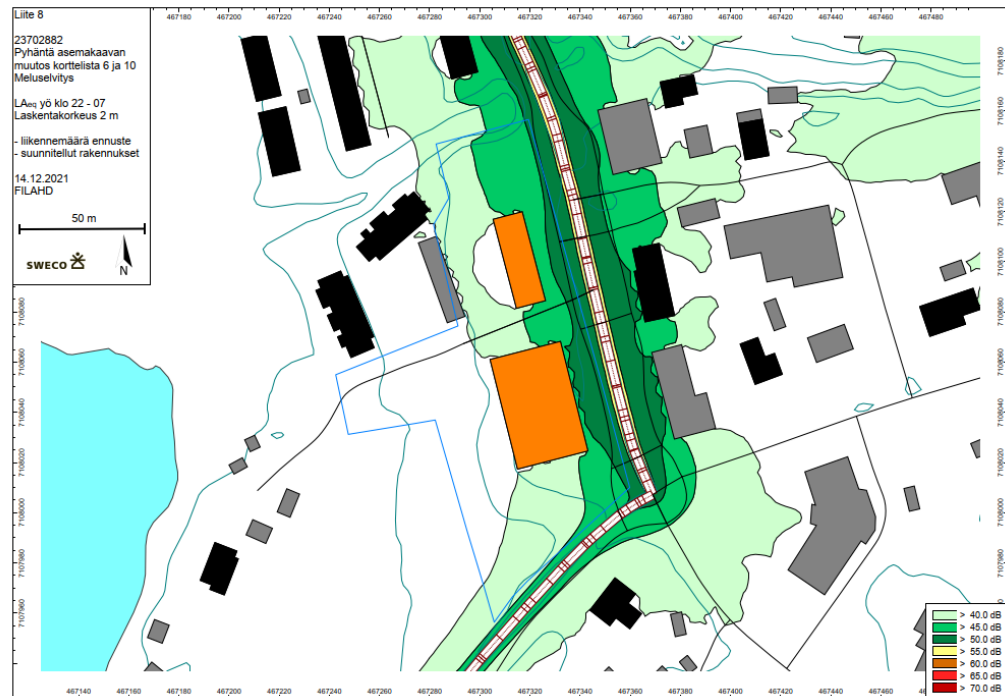
Liikenteen yöllä aiheuttama melu ennustetilanteessa.
