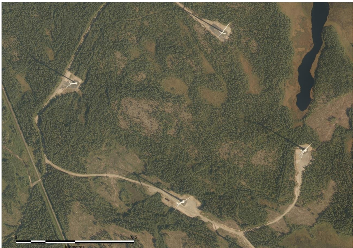
Kuva 2-9 Ilmakuvasa näkyy toiminnassa olevia tuulivoimaloita. Tuulivoimaloita varten on rakennettu huoltotiet ja nostokentät. Tuulivoimaloiden ympäristössä ja välialueilla aikaisempi maankäyttö on säilynyt ennallaan.
